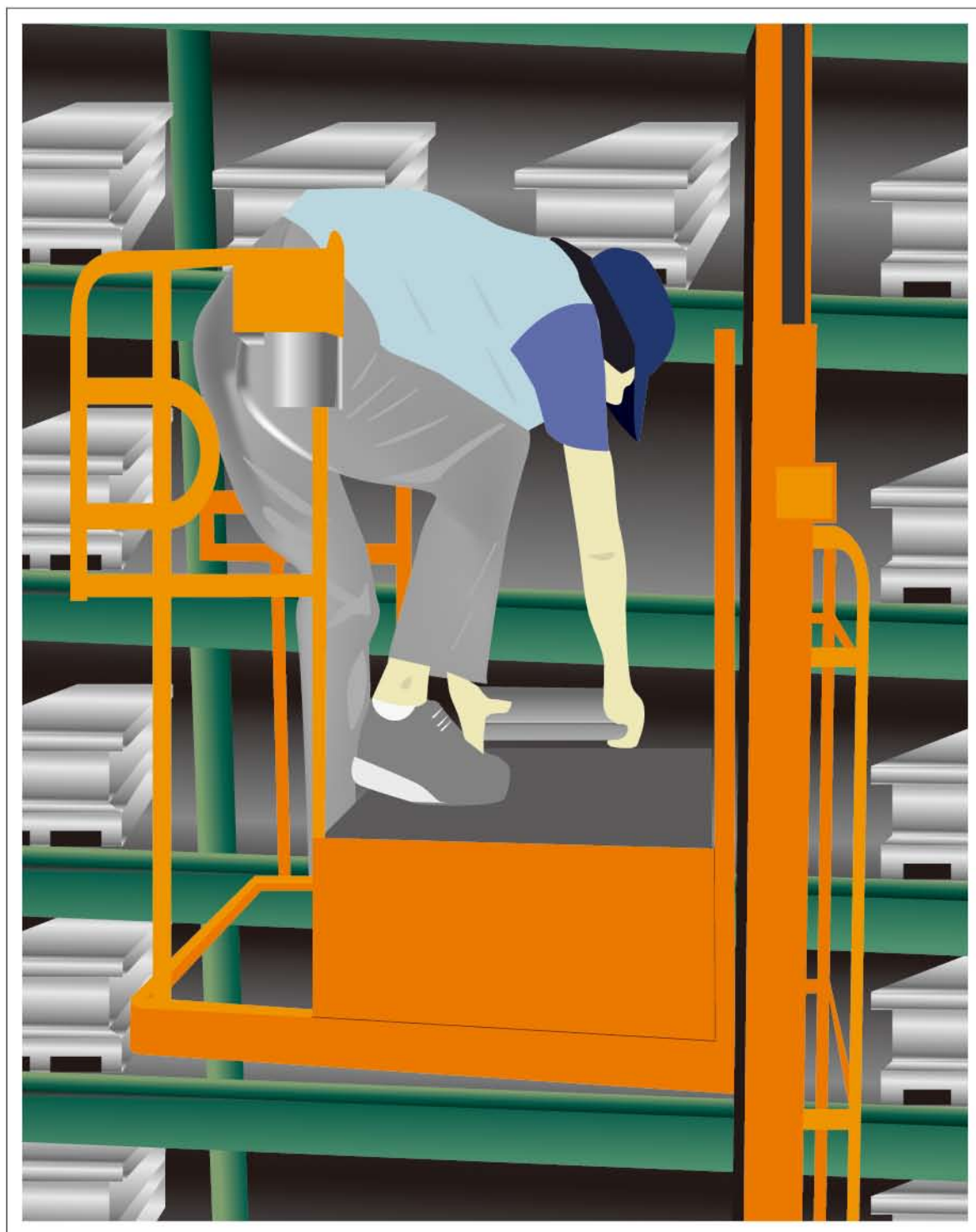
正在进行往电动起重机上装载冲切模具的作业
