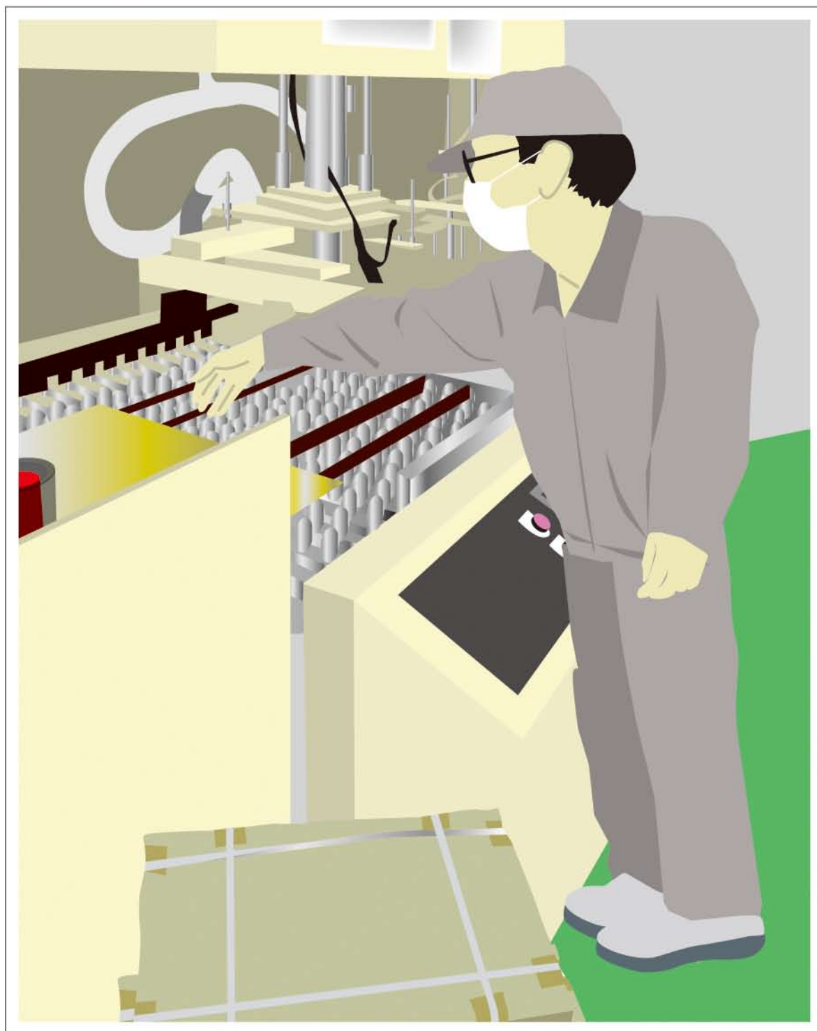
图形形成工序中发生卡壳，正在进行修复作业
