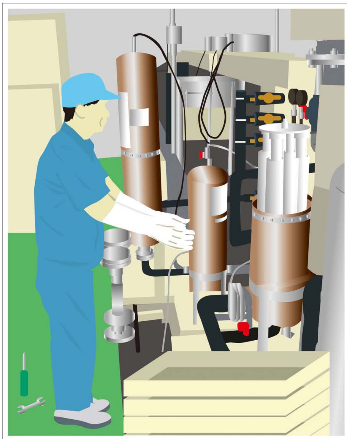
フィルター交換のメンテナンス作業中
