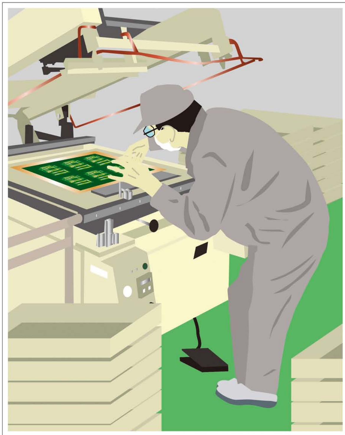
印刷機へワークをセットしているところ
