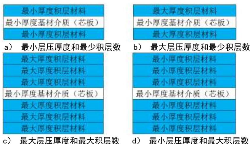
图C.11 HDI 燃烧性测试样板叠层结构示意图
