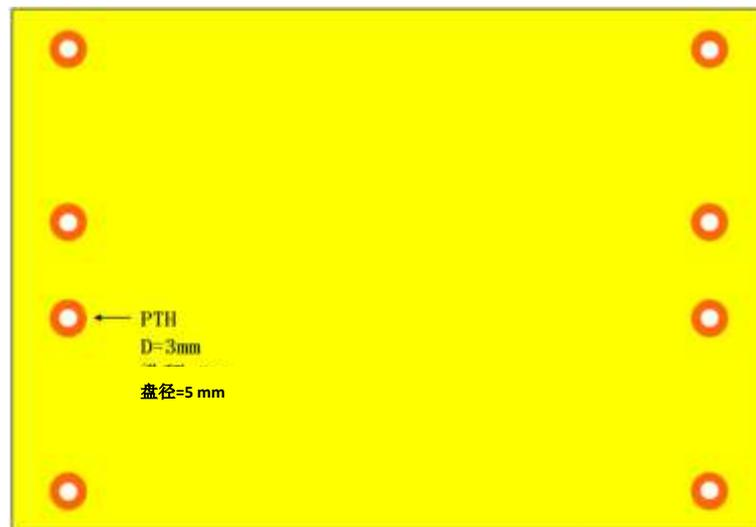
图P.1 高压绝缘测试(胶合粘结测试)图形
