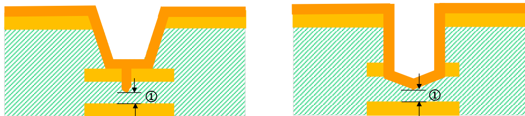
a) 盲孔目标连接盘的非故意刺穿（激光钻孔）
