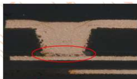
图 49 盲孔孔底松散
