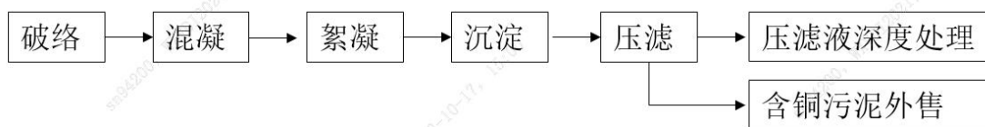
图1 棕化废液预处理工艺流程图
