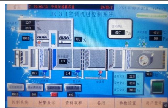
图 3 空调控制面板
