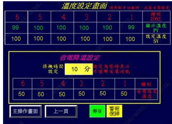
涂布烘箱设备节电控制界面
